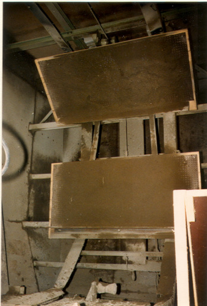
Bild 5. Spritzbetonfläche oben: Palettenstellung 2 (45 o -Stellung) unten: Palettenstellung 1 (senkrechte Lage)
