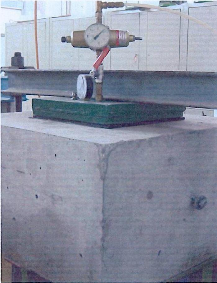
Bild 5: Mit *KB-Flex 200* abgedichteter Ringspalt während der Prüfung der Druckwasserdichtigkeit
